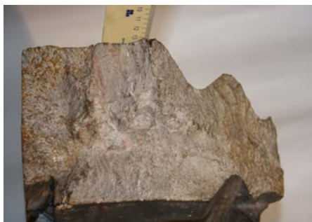
Фиг. 1. Фрагмент от преждевременно излязъл от строя чук
