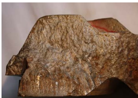
Фиг. 2. Фрагмент от добре работил чук
