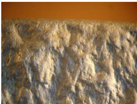
Фиг. 4. Ръб на добре работил чук (проба 2), 20x
