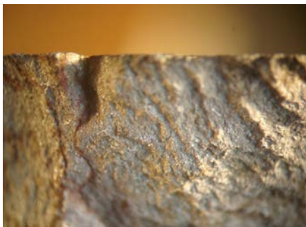
Фиг. 3. Ръб на дефектирал чук (проба 1), 20x
