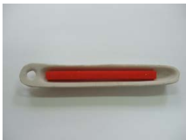
Фиг. 5. Пробни тела от PLA (80x10x8mm) изработени чрез екструдирание с 3D принтер Velerman K8200 за изследване на изгарянето на материала при различни температури.
